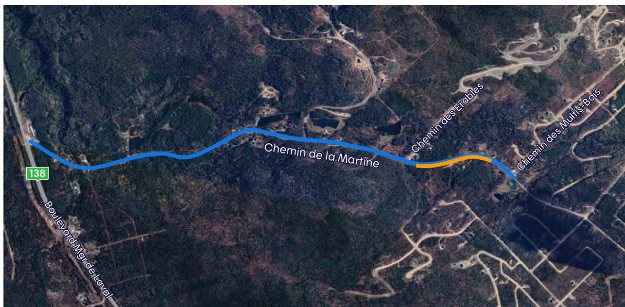
— Sections du réseau monophasé qui seront remplacées par un réseau triphasé.
